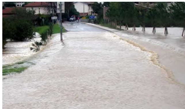
Slika 19 in 20: Visoke vode Vipave leta 2010 v območju VP Zalošče (kota gladine ca. 59,35m.n.v., izračunana ca. 59,33m.n.v.)
