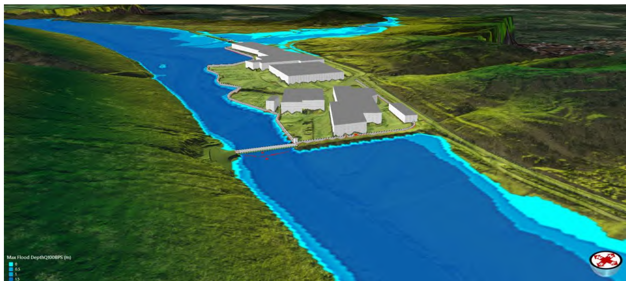
Slika 31: Prikaz rezultatov hidravličnega modela za predvideno stanje pri pojavu stoletnih voda
